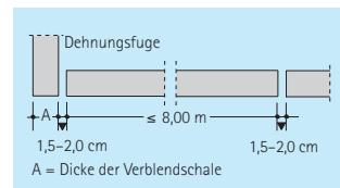
Diese sollten maximal 8 m Abstand haben und an den Gebäudeecken sowie in der Verlängerung der Tür- und Fensteröffnungen positioniert werden. Nach der Fertigstellung müssen die Fugen dauerelastisch geschlossen werden.
