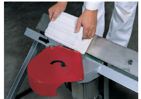
10. Passsteine werden nach dem Sägen auf der Schleifmaschine oder einer Handfasenlehre angefast.
